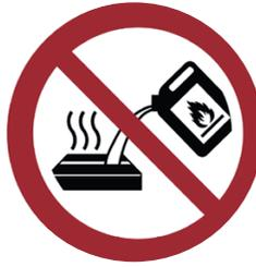
Brennstoff nicht in die heiße Brennkammer einfüllen
