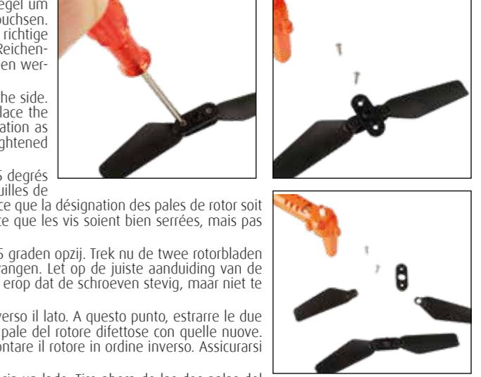
**DE** Demontieren Sie die einzelnen Rotorblätter und schwenken Sie den oberen mittleren Riegel um 45 Grad zur Seite. Ziehen Sie nun die beiden Rotorblätter nach oben weg von ihren Halterungsbüchsen. Nun können Sie die defekten Rotorblätter durch neue austauschen. Achten Sie bitte auf die richtige Rotorblätter-Bezeichnung, wie oben erklärt. Bauen Sie nun den Rotor wieder in umgekehrter Reihenfolge zusammen. Achten Sie darauf, dass die Schrauben, zwar fest, aber nicht zu fest angezogen werden.
